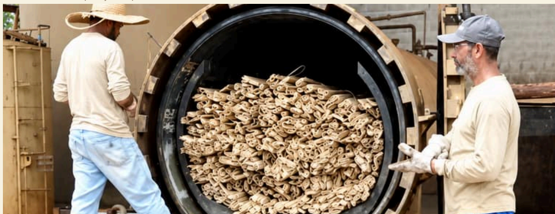
Lote de ripas de bambu submetidas a tratamento industrial em autoclave com CCA. O processo promove a impregnação do preservante no material, contribuindo para sua durabilidade e proteção contra agentes xilófagos, conforme a especificação de tratamento.
